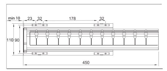
Разметка для установки системы на левую сторону. Для установки на правую сторону отзеркальте размеры.
